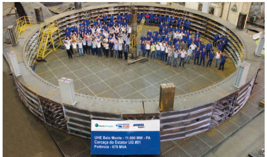
▼ Estator para CH Belo Monte durante su fabricación
