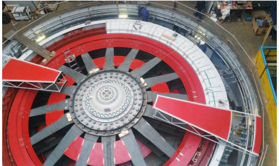
▲ Montaje de tapas y escudos de aire
