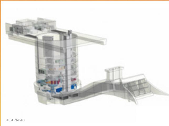
O design final se baseia em uma usina reversível, com duas unidades moto-geradoras de turbina, com 125 MW cada.
