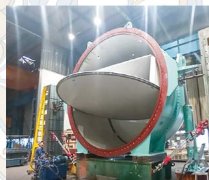
PIV durante o FAT (Teste de Aceitação de Fábrica) na oficina da ANDRITZ na Hungria
