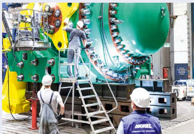
Teste de pressão e aceitação de fábrica da primeira de seis válvulas esféricas para Dinorwig na presença do cliente no outono de 2022
